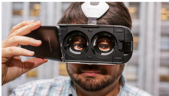
Figure 2 : Samsung Gear donnant la possibilité d'insérer son smartphone en lieu et place de l'écran de l'Oculus Rift.
